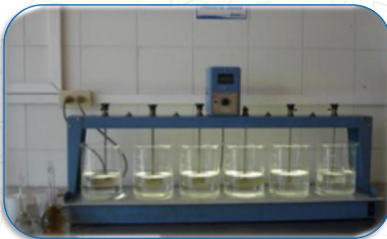
Ilustración 27 Prueba de jarras – Laboratorio PTAP Nuevo Horizonte
